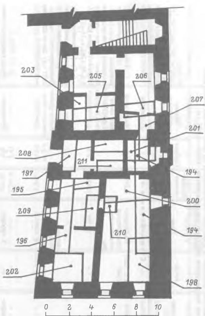
Рис. 3. План расположения шурфов в южной части Никитского корпуса.
